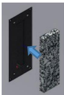
d) Die mitgelieferte Bauschutzkappe in die Unterputzdose einsetzen
