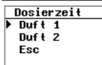
Die Dosierzeit definiert den Zeitraum in dem der Kleinkompressor läuft und der Duft in die Kabine geblasen wird.
